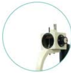
Der Gelbfilter ist in der SL115 integriert.
